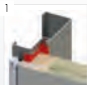
1 Wypełnienie skrzydła PEŁTA SKALNEJ WEŁNY MINERALNEJ
